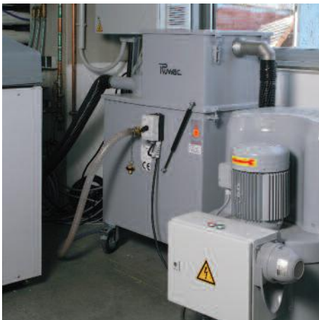
NA 250 Artık toz filtresiz çelik sac plastik işlemede emme cihazı ile
