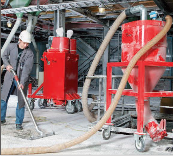
Ön separatör ayrı bir şaside
